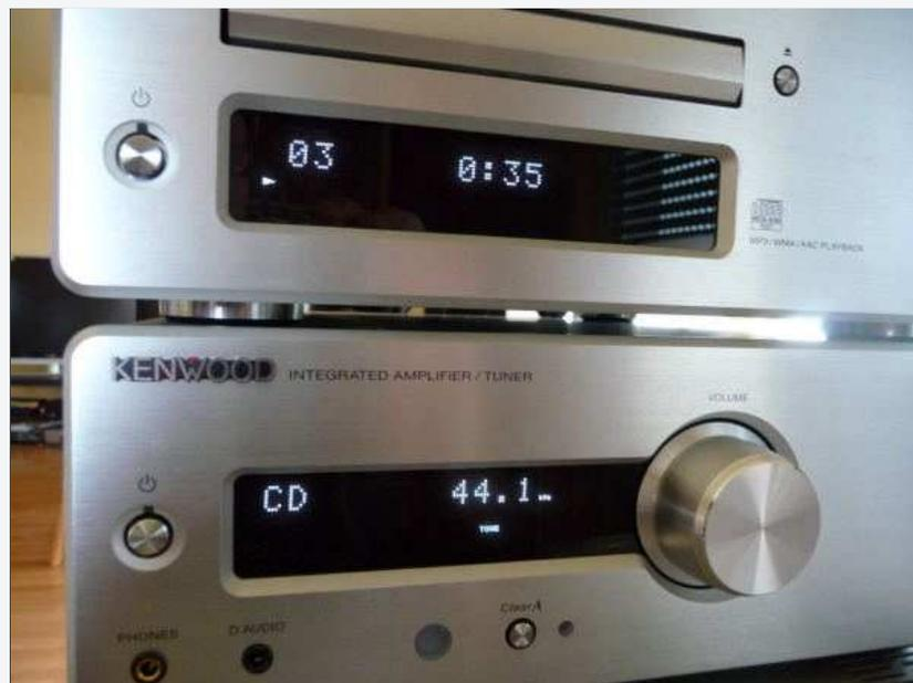
CD-Player und Stereoreceiver verfügen über Punktmatrixdisplays. Bei der CD-Wiedergabe wird im Display des Receivers die Samplingfrequenz angezeigt
