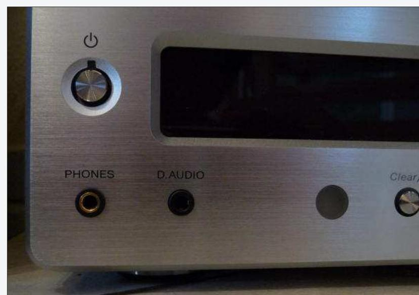
Gebürstete Alu-Fronten, akkurat eingepasste Buchsen und Bedienelemente. An die "D Audio"
