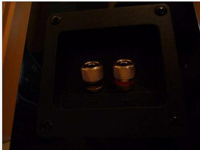
Lautsprecherkabel-Schraubanschlüsse, vergoldet, auf den Rückseiten der Boxen
